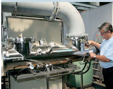
UV-Trinkwasserdesinfektionsanlage am Prüfstand im Arsenal Wien. Die Anlage ist mit vier Hg-Mitteldruckstrahlern mit je 3,5 kW elektrischer Leistung ausgerüstet.
